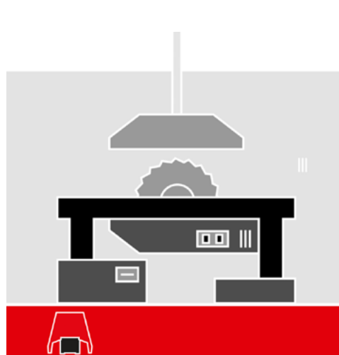
木工机器上带有保险扣和手动复位功能的脚踏开关
