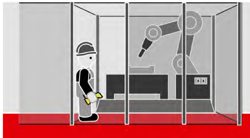
通过手动操作的使能开关指导机器人工作。
